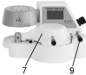
Druckglocke (7) durch drehen des Verriegelungsgriffes (9) gegen den Uhrzeigersinn entriegeln.
