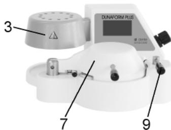
Druckglocke (7) von der Heizglocke (3) bis zum Anschlag wegschwenken.
