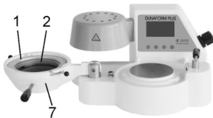
Druckglocke (7) abheben und um 180° bis zum Anschlag schwenken.
