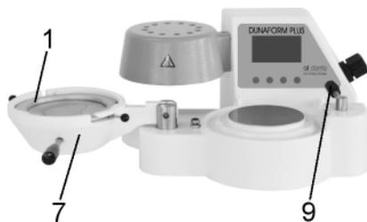
Druckglocke (7) durch drehen des Verriegelungsgriffes (9) gegen den Uhrzeigersinn entriegeln, dabei von oben auf die Druckglocke (7) drücken.
